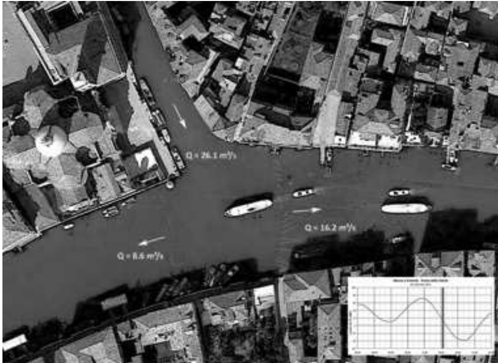
Fig. 2 - Misure di portata nel nodo Canal Grande-Canale di Cannaregio nei pressi della chiesa di San Geremia effettuate il giorno 26/11/2011 nella fase di marea calante fra le ore 15.06 e le ore 15.17. Nelle tre sezioni del nodo le misure non sono contemporanee, ragione per cui la continuità non può essere rigorosamente rispettata.
