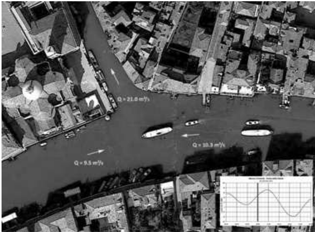
Fig. 1 - Misure di portata nel nodo Canal Grande-Canale di Cannaregio nei pressi della chiesa di S.Geremia effettuate il giorno 26/11/2011 nella fase di marea crescente fra le ore 8.57 e le ore 9.06. Nelle tre sezioni del nodo le misure non sono contemporanee, ragione per cui la continuità non può essere rigorosamente rispettata.
